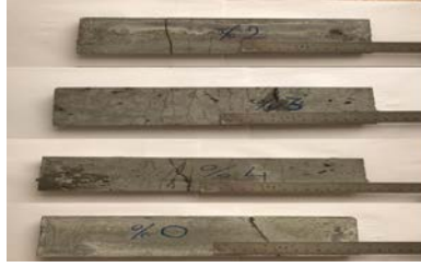
Resim 3. PVA lifli harçların eğilme deneyi sonrası çatlak görünüşleri sırasıyla %4, %3
