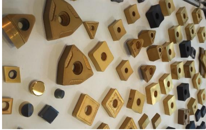
Şekil 8.Fgm Teknolojisi Kullanılarak Üretilmiş Kesici Uçlar (ELMAS UÇ / Edmaks, n.d.)
