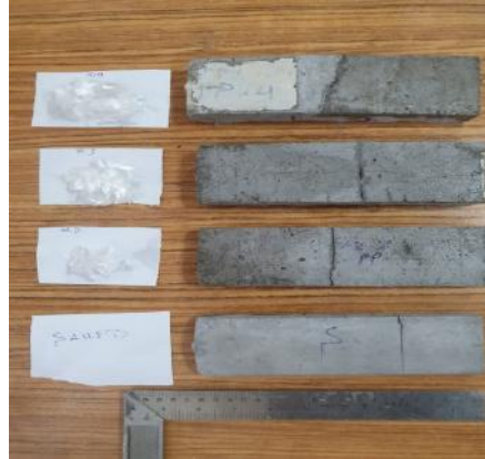
Resim 2. PP lifli harçların eğilme deneyi sonrası çatlak görünüşleri sırasıyla %4, %3, %2 ve %0
