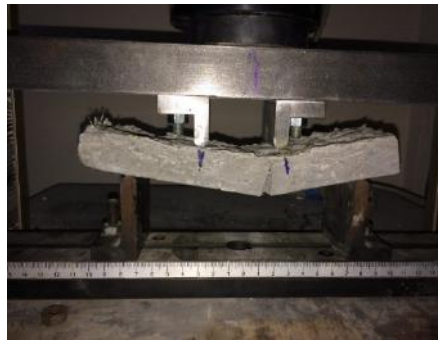
Resim 1. Farklı lif katkılı sertleşmiş beton dört noktalı eğilme deneyi.
