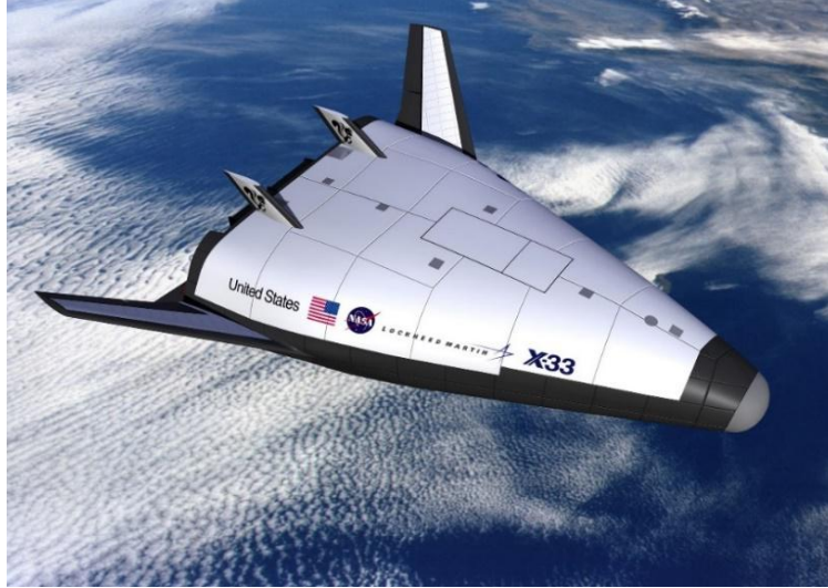
Şekil 15. FGM Isıl Bariyerlerle Kaplanmış, Tekrar Kullanılabilir Uzay Aracı ( Lockheed Martin X-33 / NASA, n.d. ).
