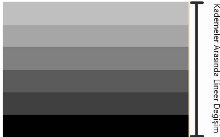
Şekil 5. Kimyasal Bileşim Katmanlı Fonksiyonel Kademelenendirilmiş Malzeme (Paterson et al., 2012)
