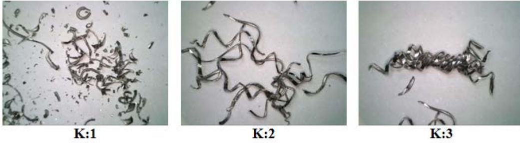
Şekil 6. Kılavuz profiline bağlı oluşan talaşlar
