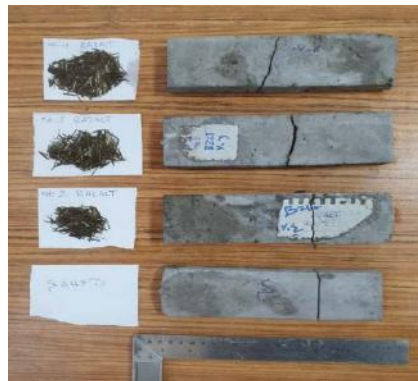
Resim 3. bazalt lifli harçların eğilme deneyi sonrası çatlak görünüşleri sırasıyla %4, %3, %2 ve %0
