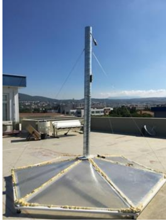
Şekil 3. Model Güneş Bacası Sistemi (Canata, 2021; Özdamar vd., 2021)
